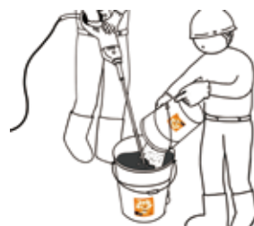
先ほど混ぜた粉末のペール缶を 液体のペール缶の中に入れます
