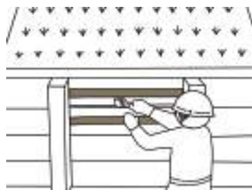
5. 継ぎ目にプライマーを塗布します。
