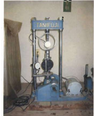
写真-6 圧裂試験
