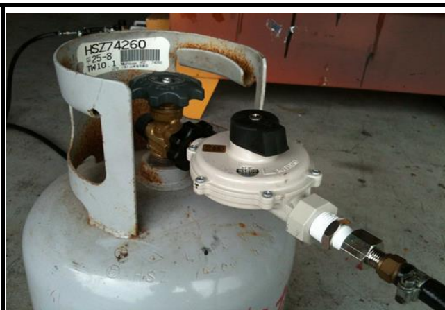
②-1 溶解釜の準備 ガスボンベの取り付け
