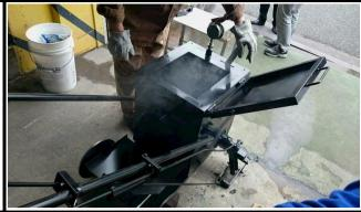
②準備工 たまに溶解釜の蓋を開け、撹拌する。(厚手の 手袋をし、火傷には注意してください)
