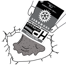
2. 充填 袋を手で破り充填します
